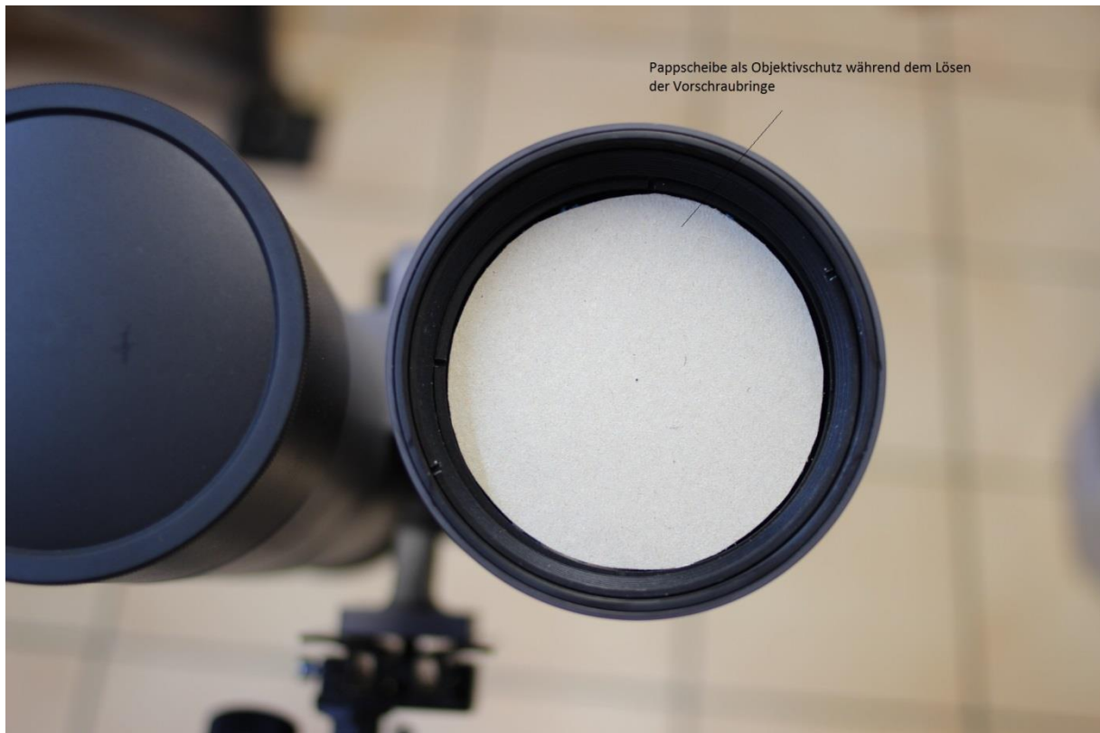
Bild 6: Pappscheibe auf dem Mikrofasertuch während dem Lösen der Vorschraubringe
