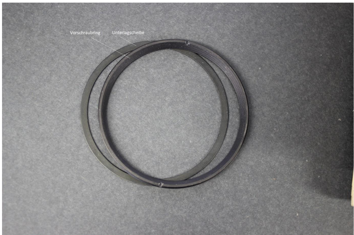
Bild 7: Vorschraubring mit Stahlring als Unterlegscheibe nach dem Lösen
