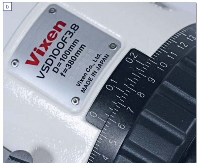
▲ Abb. 2: Der Refraktor macht einen kompakten und durchdachten Eindruck. Im Bild ist der Nonius am Okularauszug (b) und die Adaption einer Kamera (a).
