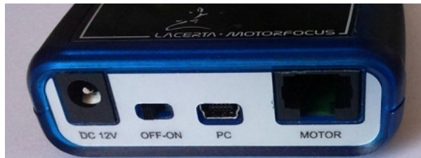
Anschlüsse an der Handbox
