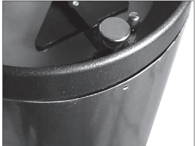
Abbildung 20. Suchen Sie den ausgebeulten Bereich des Optikrohrs, der verhindert, dass der Endring vollständig richtig sitzt.
