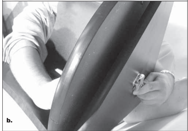
Abbildung 8. Achten Sie darauf, die Basisplatten zum Montieren nur leicht zu kippen, wie in der Abbildung gezeigt. Stellen Sie sie nicht auf die Seite. (a) Halten Sie die Kontermutter mit einem Schraubenschlüssel (oder einer Zange) fest, (b) während Sie die Schraube für die Azimut-Achse mit einem anderen Schraubenschlüssel drehen.
