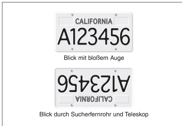
Abbildung 40. Der Blick durch ein gerades Sucherfernrohr / Spiegelteleskop ist um 180° gedreht. Dies gilt auch für das XX12-Teleskop und sein Sucherfernrohr.
