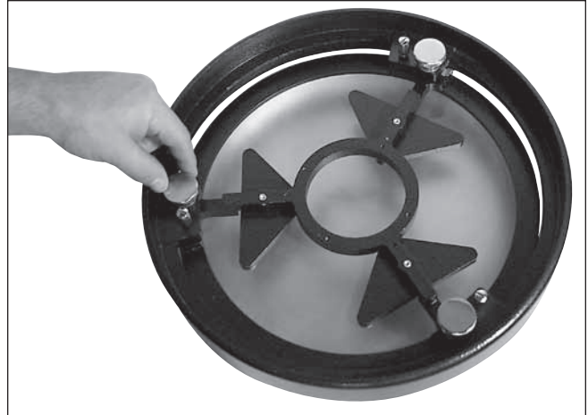
Abbildung 36. Die Neigung des Primärspiegels wird durch Drehen einer oder mehrerer der drei großen Rändelschrauben für die Kollimation eingestellt.
