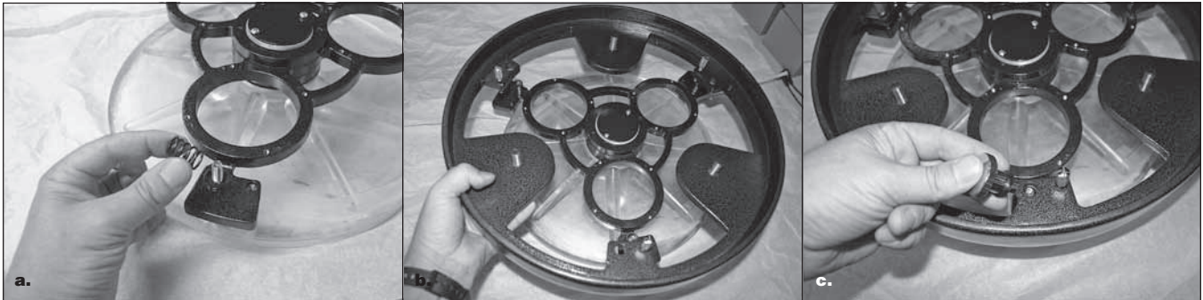
Abbildung 20. a) Legen Sie die drei Federn auf die frei liegenden Gewineschäfte der Spiegelzelle ab, sodass die Gewineschäfte durch den Endring passieren, und der Endring auf den Federn ruht. b) Senken Sie den hinteren Endring auf die Spiegelzelle ab, so dass die Gewineschäfte durch den Endring passieren, und der Endring auf den Federn ruht. c) Schrauben Sie die Kollimationsknöpfe mit eingesetzten Nylon-Unterlegscheiben durch den hinteren Endring und auf die Gewineschäfte. Stellen Sie sicher, dass die Knöpfe mindestens drei volle Umdrehungen auf die Schäfte geschraubt worden sind.
