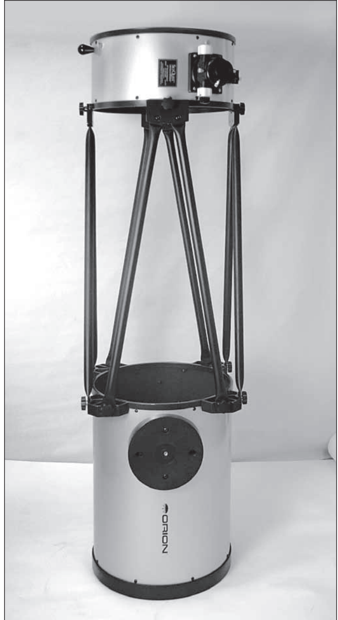
Abbildung 25. Nachdem das Optiktrohr montiert wurde, sollte der obere Optiktrohrabschnitt wie in der Abbildung gezeigt zum unteren Abschnitt ausgerichtet sein. Beachten Sie dabei die Ausrichtung des Fokussierers am oberen Optiktrohrabschnitt zum seitlichen Höhenlader auf dem unteren Optiktrohrabschnitt.
