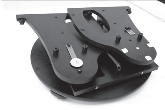
Abbildung 47. Beim Transport der zerlegten Basis, legen die Seitenwände so, dass die Drehgeber nach oben gerichtet sind und stapeln Sie nichts auf ihnen, um Beschädigungen zu verhindern.
