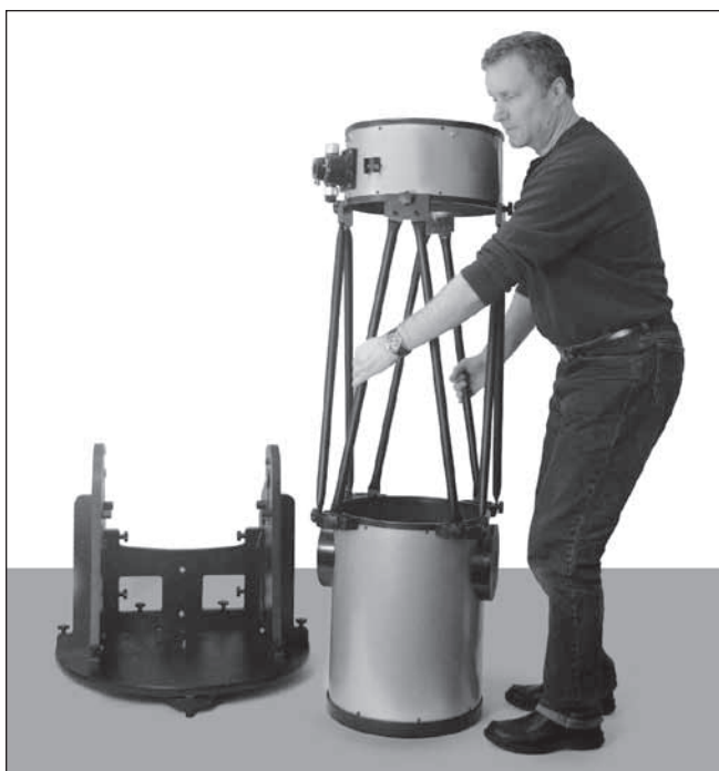
Abbildung 28. Heben Sie den optischen Tubus durch Greifen der beiden Gitterrohrstangen und senken Sie ihn vorsichtig ab, so dass die großen Höhenlager Naben auf dem Höhenlager Zylinder an den Seitenwänden ruhen.
